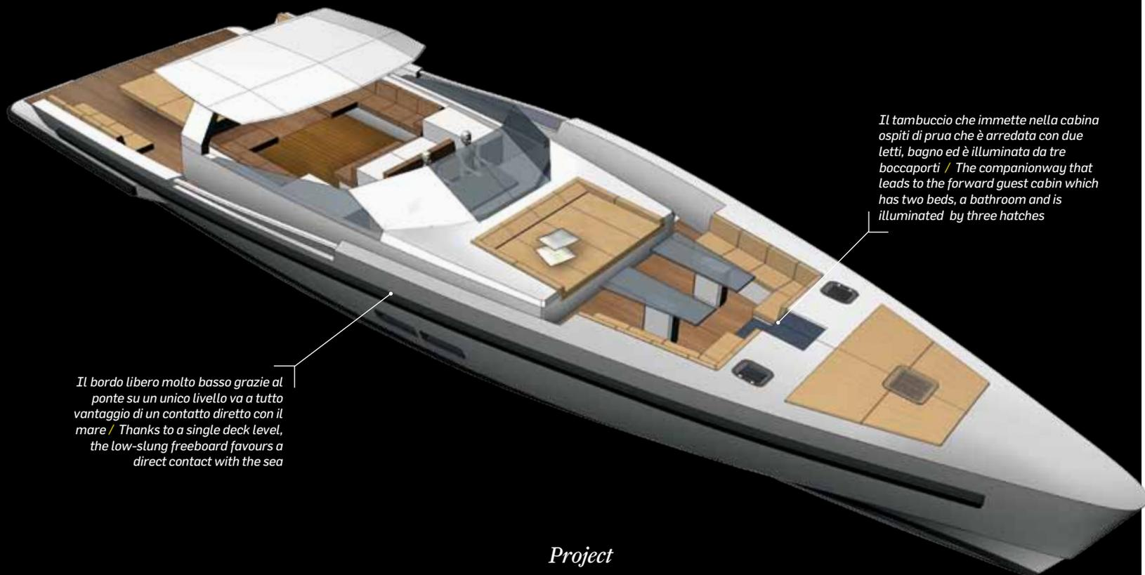
*Il bordo libero molto basso grazie al ponte su un unico livello va a tutto vantaggio di un contatto diretto con il mare / Thanks to a single deck level, the low-slung freeboard favours a direct contact with the sea*
